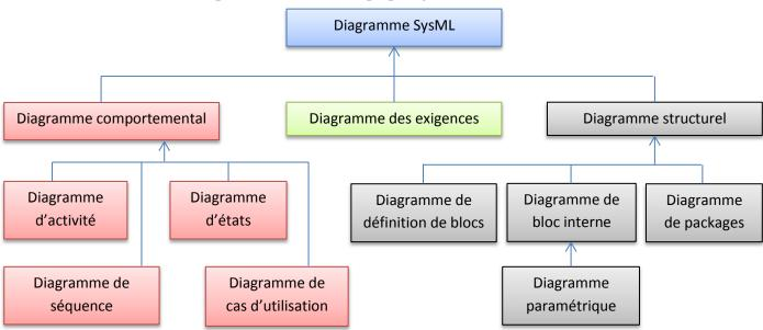
SysML est aussi une méthode de conception, les diagrammes sont donc ordonnés. La première action consiste à traduire le besoin fonctionnel en exigences en s'appuyant sur le cahier des charges. En sciences de l'ingénieur on effectuera des analyses de systèmes, on comparera donc le système modélisé par le langage SysML avec le système réel.
